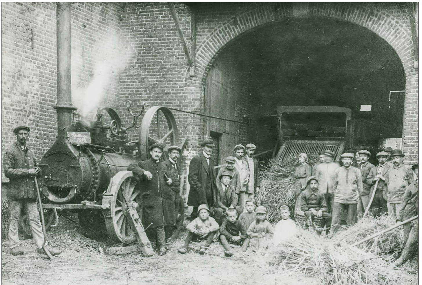
Een hele groep mensen - arbeiders, bewoners en nieuwsgierige kinderen - bij een locomobiel die een dorsmachine aandrijft.
